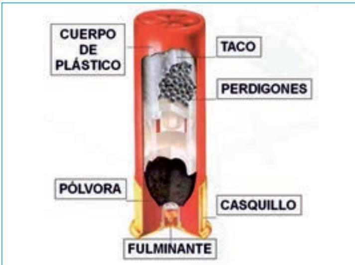
Imagen número 3. Componentes de un cartucho semimetálico.
