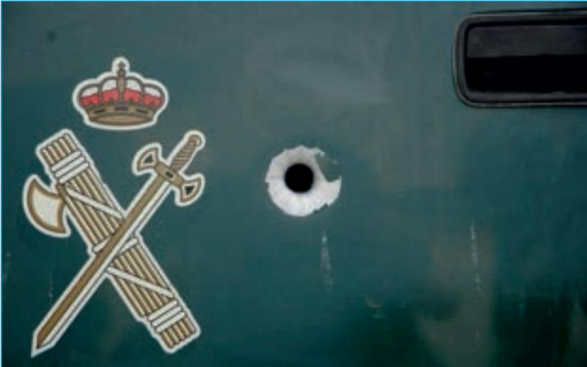
Imagen 2. Disparo perpendicular en chapa con proyectil que no es de alta velocidad.
