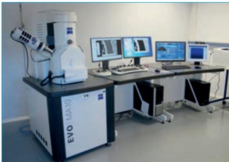
Foto 3. Microscopio electrónico de barrido con microanalizador de energía dispersiva de rayos x
