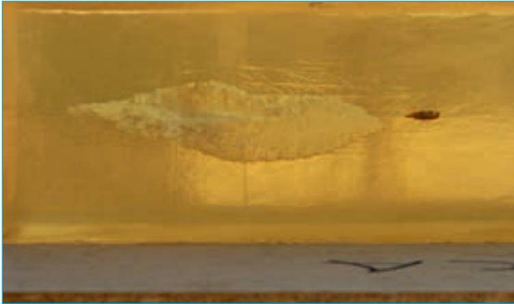
Foto 38: Perforación sobre gelatina balística de una bala del Ø 5.7 mm (pistola FN Five Seven) (Dpto. de Ciencia y Técnica Policial - ENP)
