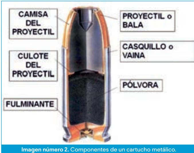
Este tipo de munición tiene dos claros sistemas de denominación: Anglosajón y Centroeuropeo. En el primero de ellos se denomina el calibre de los cartuchos en pulgadas, en cambio, en el segundo la denominación viene dada en milímetros.
