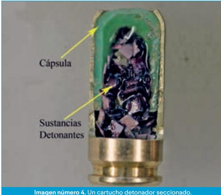
Imagen número 4. Un cartucho detonador seccionado.
