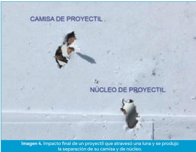
Imagen 4. Impacto final de un proyectil que atravesó una luna y se produjo la separación de su camisa y de núcleo.
