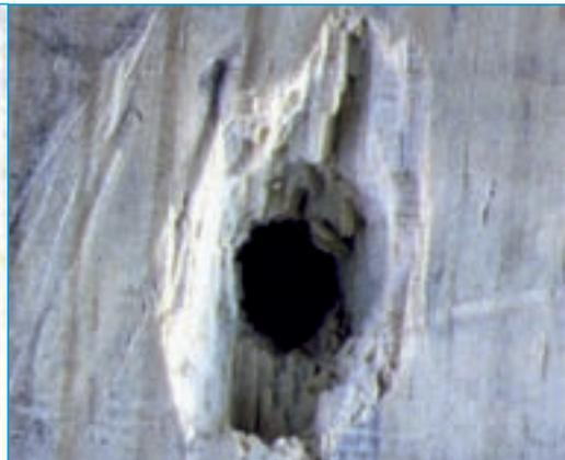
Foto 21: Orificio de salida -impacto perpendicular- (Dpto. de Ciencia y Técnica Policial - ENP)
