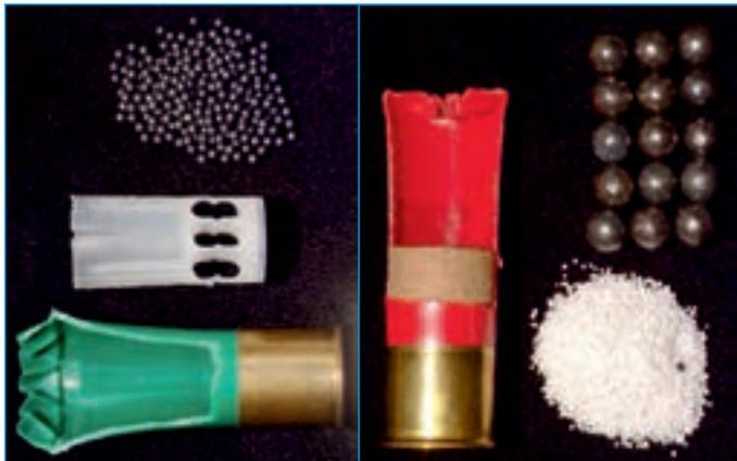
Imágen 40. Componentes de cartucho de escopeta. A la izquierda con perdigones y la derecha con postas.
